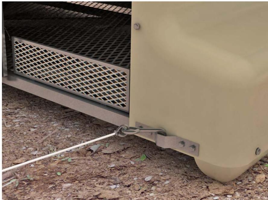
Figura 1.3.34: Detalle de gancho de remolque en uso
